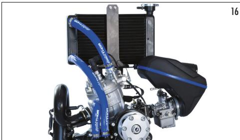
Fixer l'étrier grand en dotation entre les deux silentblocs en haut et le châssis. Monter les deux caoutchoucs sur l'étrier et poser le radiateur. Pour fixer le radiateur dans la partie supérieure on fournit un étrier et un caoutchouc. Couper à mesure les durites de l'eau et les monter. Serrer les colliers en dotation en utilisant une pince spéciale pour le montage (photo 17).
