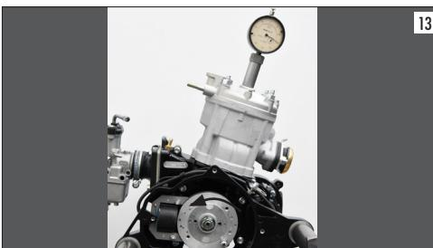
A valore raggiunto, con una mano tenere fermo la puleggia o l'albero motore nella parte opposta e con una chiave bloccare il dado del volano, ma senza eccedere. Riverificare che l'antico sia nei valori segnalati ( $3,7 \pm 0,1$ ) togliere la vite m.5x30 e montare la bobina. Prima di bloccarla con le due viti interporre fra bobina e volano uno spessore calibrato da 0,35 mm (foto 14).
