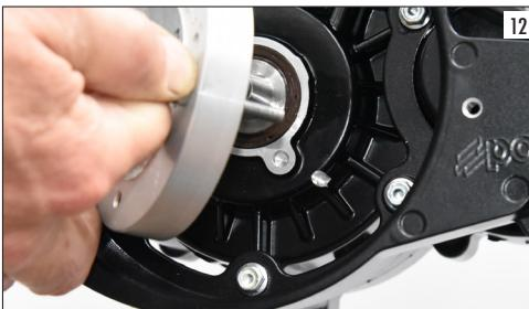
Visser l'écrou du volant sans le serrer de façon à ce que le vilebrequin puisse tourner dans le volant. Visser le support du comparateur dans le trou de la bougie, placer le comparateur et mettre le piston au PMS. Mettre à zéro le comparateur et tourner le vilebrequin dans le sens antihoraire de 3,7 mm en regardant du côté du volant (voir flèche, photo 13).
